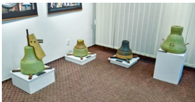
Modely postupu výroby formy pro lití zvonu.
