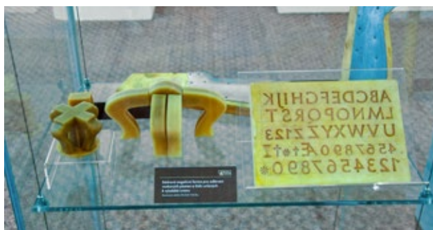
Voskové pomůcky pro výrobu formy zvonu a pro lití voskových písmenek.
