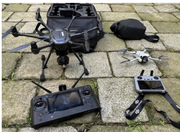
Vlevo „důchodce“ Typhoon s ovladačem a přepravním obalem, vpravo „nováček“ DJI Mini 4 Pro s ovladačem a brašnou ukrývající navíc nabíječku s dvěma náhradními bateriemi, umožňujícími za den pracovat až 1,5 hod.
