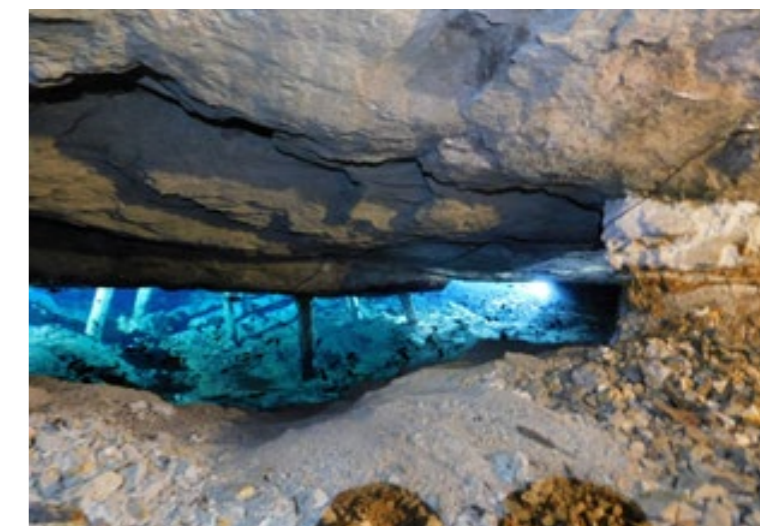
Obr. 4: Zatopené hloubení ve štole sv. Václava s nedotěženou křemennou žílou
