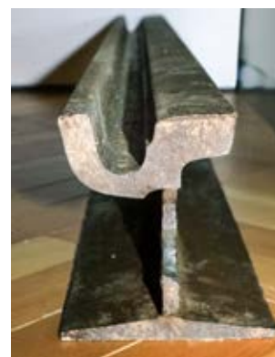
Profil tramvajové kolejnice. Foto: Martin Kos – MVJ
