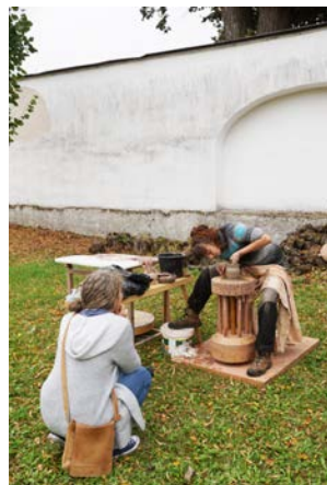
Obr. 8: Výroba keramické nádoby na kopacím hrnčířském kruhu zvaném „špružlák“.
