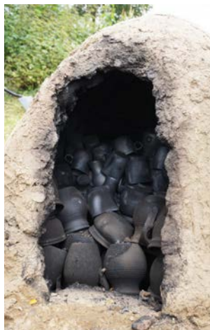
Obr. 7: Experimentální výpal keramiky – vsádka pece.
