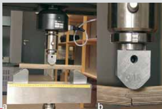
Měření pevnosti impregnovaného dřeva v ohybu, a) před zatížením, b) po zatížení.
