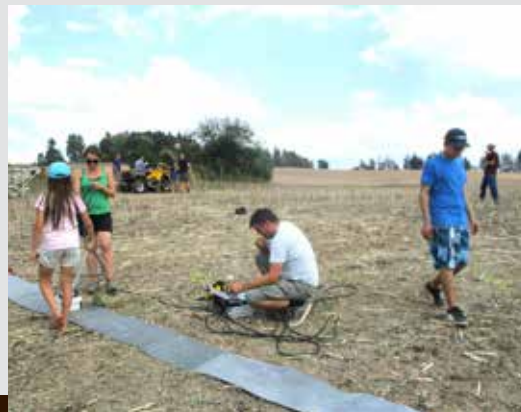
Profilování georadarem – výzkum vápenické pece.
