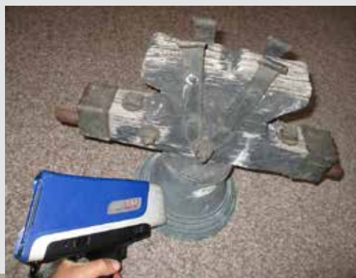
pXRF spektrometr, ukázka měření, bron- zový zvon
